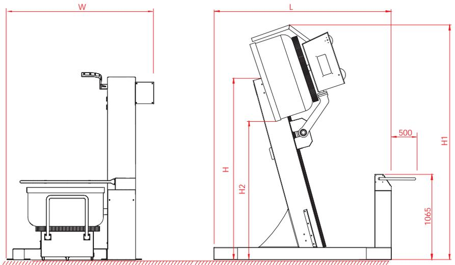
Автоматический дежеподъемопроектируемый подходит для работы с автоматическим спиральным тестомесителем с подкатной дежой Porlanmaz. Машина переключает тесто замешанное в тестомесителе с подкатной дежой в тестоделитель. Способствует серийному производству. Когда дежа поднимается на максимальную точку машины, дежа поворачивается автоматическая и все тесто выгружается с помощью скребка. Когда процесс выгрузки заканчивается дежа снижается очень мягко с помощью устройства контроля скорости.
